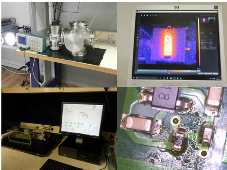
Bancs de tests de LEDs avec systèmes LiFi (éclairage, colorimétrie, thermique, ...)
