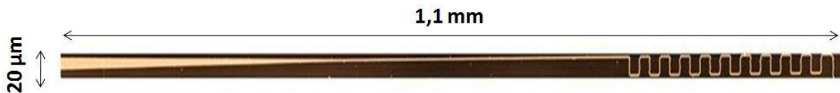
Figure 4-10 : Image topographique du guide d'onde en forme de serpent. Les dimensions de l'image sont de 1,1 mm x 20 \mu\text{m} et les résolutions de 20 nm x 100 nm selon les axes rapide et lent respectivement, ce qui donne 55000 points par ligne. La vitesse de balayage est de 40 \mu\text{m/s}
